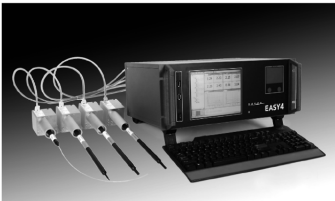
Рисунок 25 – Общий вид измерительного комплекса EASY-4 производства компании "SPEAG" (Швейцария) для контроля ЭМП РЧ ближней зоны и определения МПД
