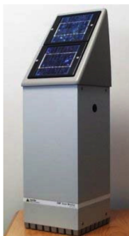
Рисунок 7 – Автономный измерительный комплекс для мониторинга ЭМО вблизи БС сотовой связи (Oliveira et al., 2007)
