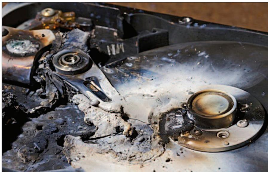
Рис. 6. Результат воздействия на жесткий диск электромагнитного поля соленоида
